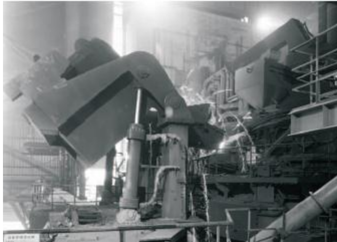
شکل ۳: کوره قوس الکتریکی آماده تخلیه
